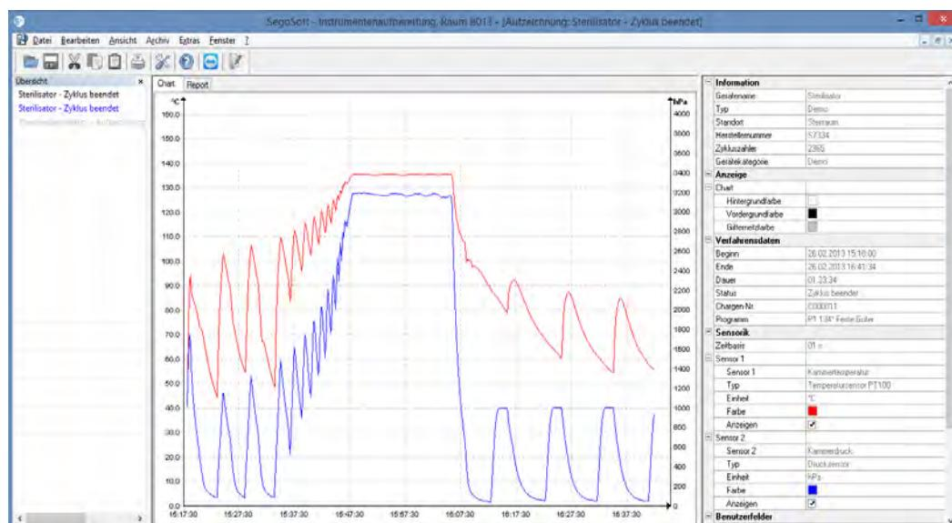
Im **Kurventeil** werden die Messwerte in Form eines Diagramms dargestellt. Die x-Achse zeigt den Zeitverlauf an. Je nach angeschlossenem Gerät zeigt die y- Achse die Temperatur z.B. in Grad Celsius (°C) und den Kammerdruck z.B. in Hektopascal (hPa) an. Die Kurven zeigen die Daten der im angeschlossenen Gerät vorhandenen und an die Software übertragenen Sensoren an.
