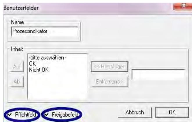
Ein Prozessindikator (Chemo-indikator Klasse 5, DIN EIN ISO 11140-1) sollte bei kritisch A Produkten laut RKIEmpfehlungen bei jedem Gerätelauf beigelegt werden. Nach der Auswertung und Dokumentation des Indikators über den Freigabe-dialog mit SegoSoft kann der Indikatorstreifen entsorgt werden, da die Aussagekraft des Streifens im Laufe der Zeit verblasst.
